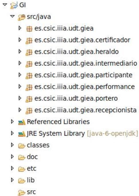
Como puede observarse, en el proyecto “GI” cada uno de los agentes que actúan dentro de la IE tiene un paquete asociado donde reside el software que corresponde a sus movimientos en la estructura performativa de la IE y sus acciones dialógicas dentro de cada protocolo.
